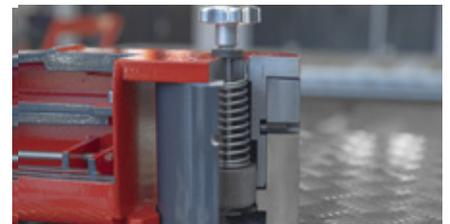
Sistema di bloccaggio interno del braccio
