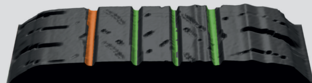
Scansione 3D dello pneumatico con TreadReader™
