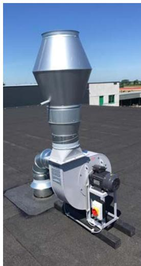
Gli elettroaspiratori GSA sono studiati appositamente per evacuare i gas di scarico e i fumi in genere dalle zone di lavoro. La costruzione è completamente realizzata in lamiera d'acciaio verniciata a polvere epossidica con motore direttamente accoppiato, girante bilanciata sia staticamente che dinamicamente, flange di entrata e di uscita dimensionate secondo la portata ottimale dell'aspiratore e piedi di sostegno per posizionamento a muro o a soffitto.
