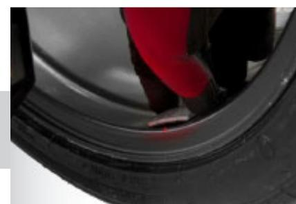
L'**EASYWEIGHT™** puntatore laser puntiforme identifica la collocazione esatta del peso.
