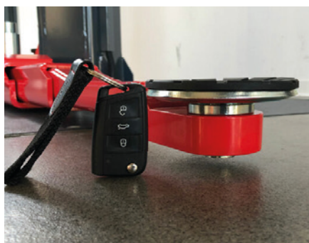
Struttura del braccio molto sottile ma comunque robusta
