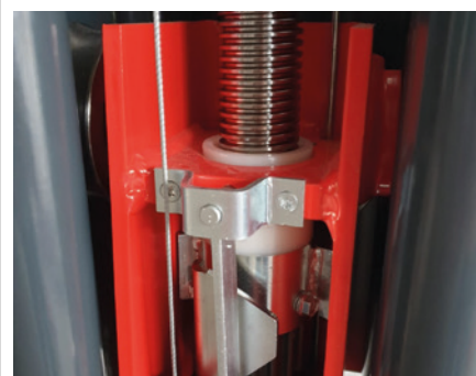
Mandrino laminato a freddo di alta qualità con sistema di sicurezza unico nel suo genere
