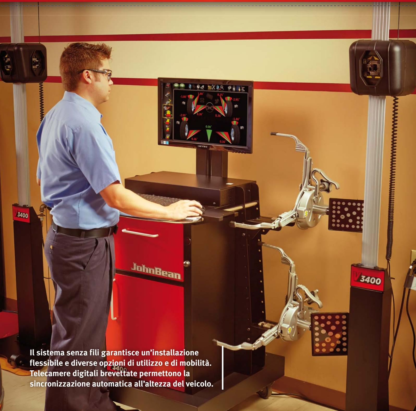
Il sistema senza fili garantisce un'installazione flessibile e diverse opzioni di utilizzo e di mobilità. Telecamere digitali brevettate permettono la sincronizzazione automatica all'altezza del veicolo.
