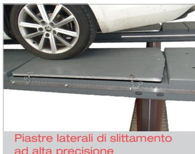
Piastre laterali di slittamento ad alta precisione
