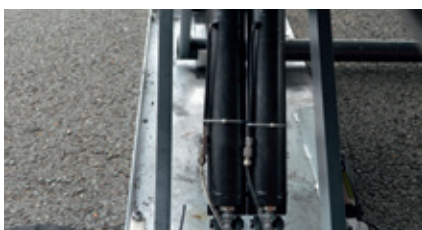
Doppio sistema idraulico, quindi non è richiesta aria compressa
