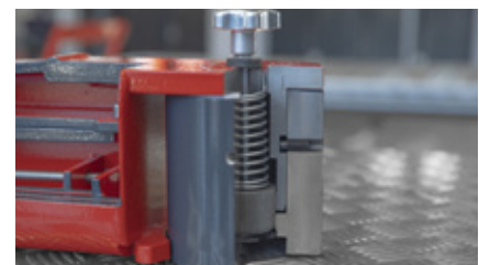
Sistema di bloccaggio interno del braccio
