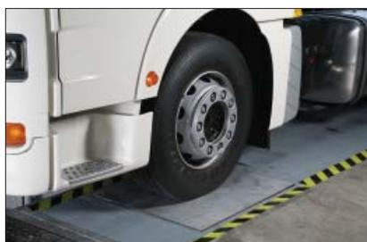
Il prova deriva è stato progettato per verificare la convergenza dell'asse in prova in modo istantaneo. Il risultato della convergenza o divergenza dell'asse viene rispettivamente visualizzato sul modulo LED e in forma grafica sul monitor.
