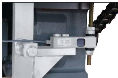
Tutte le misure sono effettuate da sensori elettronici di qualità del tipo cella di carico.
