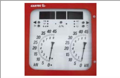
Unità di visualizzazione analogica campo di misura 0–45,5 kN
