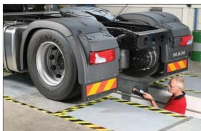
Il banco prova giochi GST 4500 è un utile complemento per l'accettazione del veicolo o il controllo visivo dei giochi dell'asse in fase di revisione. Le piastre zincate a caldo sono azionate da una centralina idraulica per mezzo dei pulsanti posti sulla torcia di ispezione. Le piastre di prova possono essere controllate singolarmente, per movimenti contrapposti (4 movimenti), o nella medesima direzione (8 movimenti).
