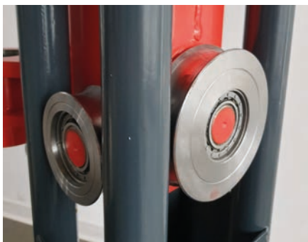
Carrello con 6 ruote guida in acciaio e cuscinetti a rulli senza lubrificazione
