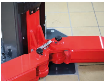
Sistema interno di bloccaggio dei bracci
